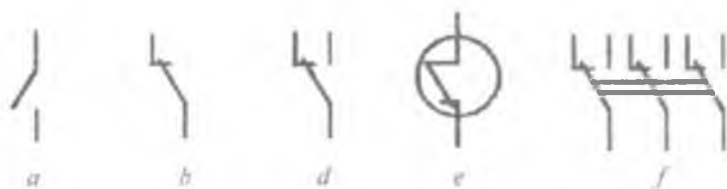
1.17-rasm. Kommutatsiya elementlarining sxemalarda shartli belgilanishi: ulovchi (a), uzuvchi (b), almashlab ulovchi (d) kontaktlar, gerkon (e) va almashlab ulagich (f).
