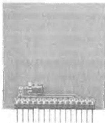
10.4-rasm. BT xarakteristikalarini tadqiq etishda qo'llaniladigan Lab4A modulining tashqi ko'rinishi.
