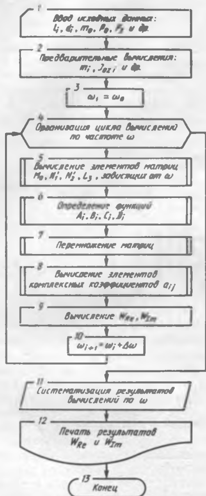
Рис. 3.17. Алгоритм определения частотной передаточной функции W
