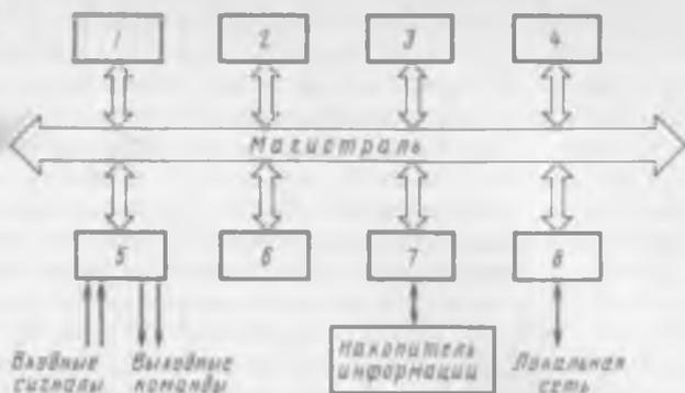
Рис. 2.31. Структурная схема универсального программируемого контроллера
