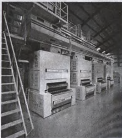
47-rasm. «Model 141» jnlari o'rnatilgan jinalash sexining umumiy ko'rinishi.
