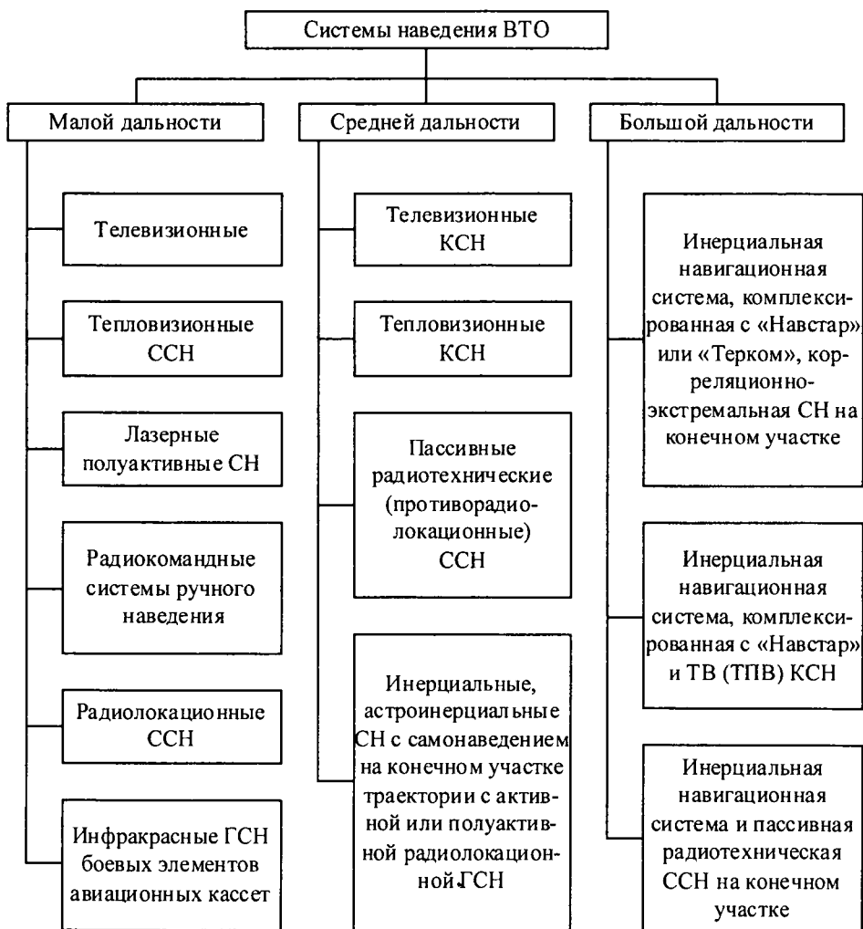
Рис. 6.10. Классификация систем наведения авиационного ВТО по типу используемой аппаратуры, установленной на боеприпасе: ССН — система самонаведения, СН — система наведения, ГСН — головка самонаведения, КСН — командные системы наведения
