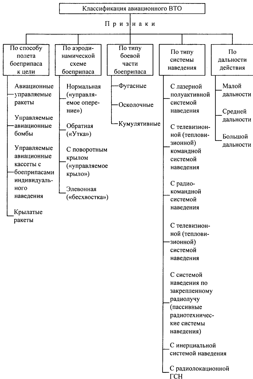
Рис. 6.8. Классификация авиационного высокоточного оружия
