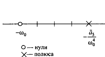
Рис. 1.84. График распределения нулей и полюсов
