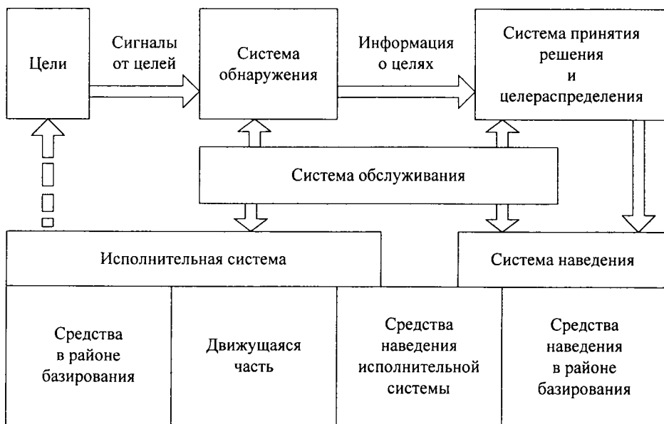
Рис. 6.6. Функциональная схема комплекса ВТО
