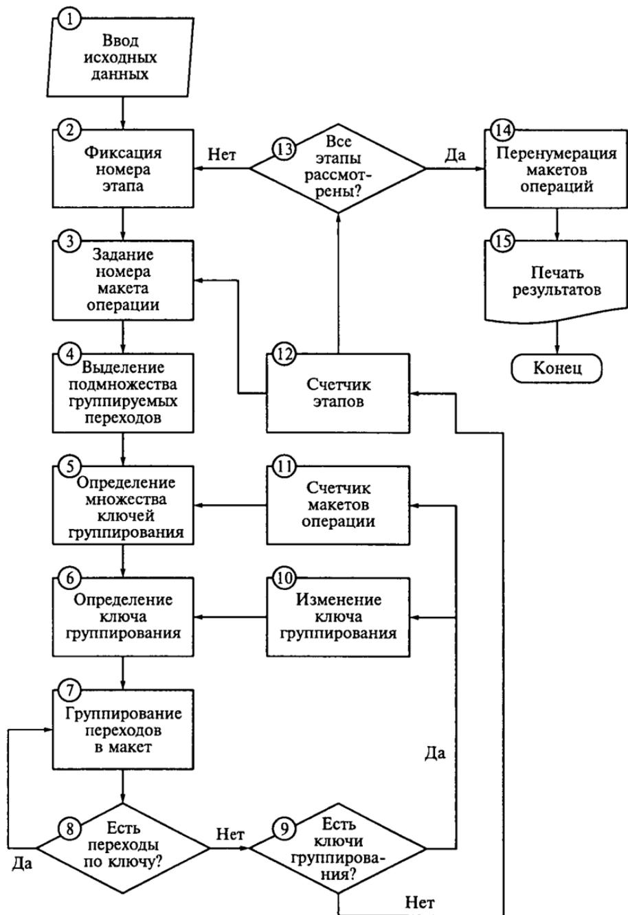
Рис. 2.12. Алгоритм макетирования маршрутного ТП изготовления деталей
