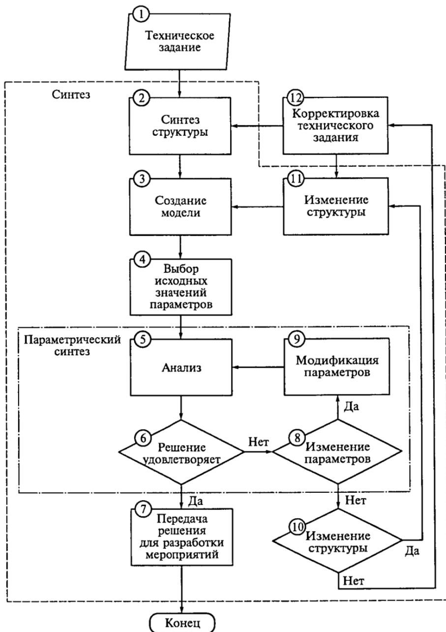
Рис. 2.4. Общий алгоритм формирования проектного решения
