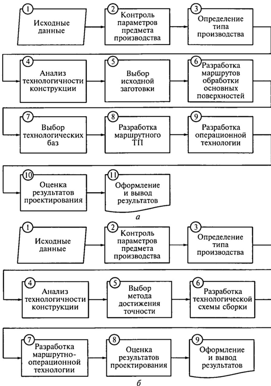
Рис. 2.1. Обобщенные алгоритмы неавтоматизированного проектирования единичных ТП:
