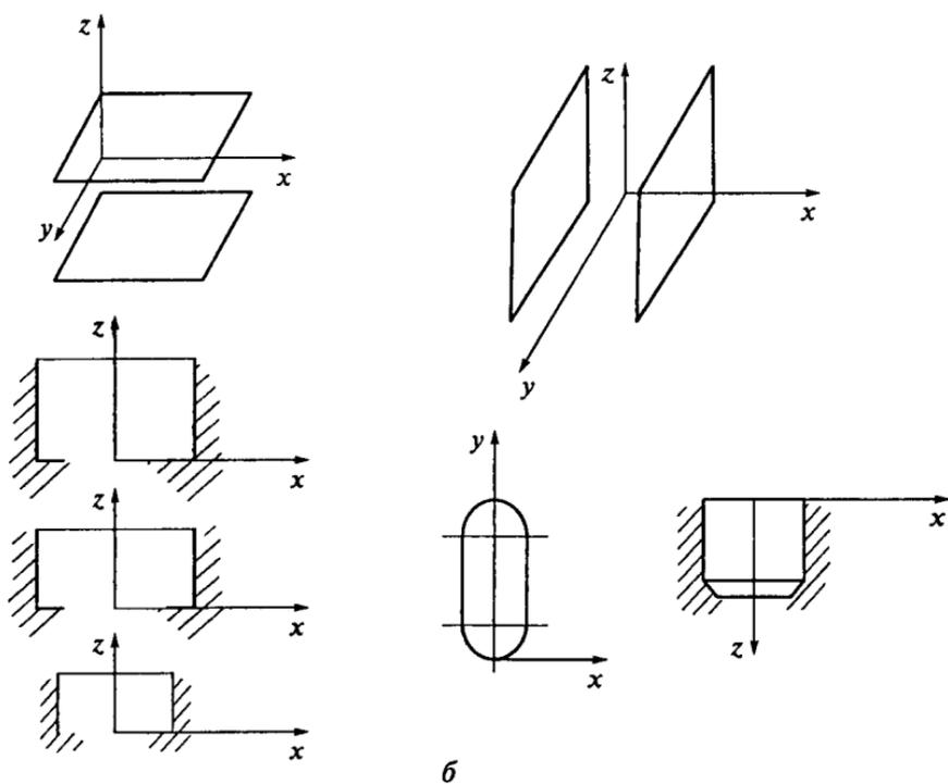
Рис. 4.3. Декомпозиция детали (а) на Т-комплексы (б)
