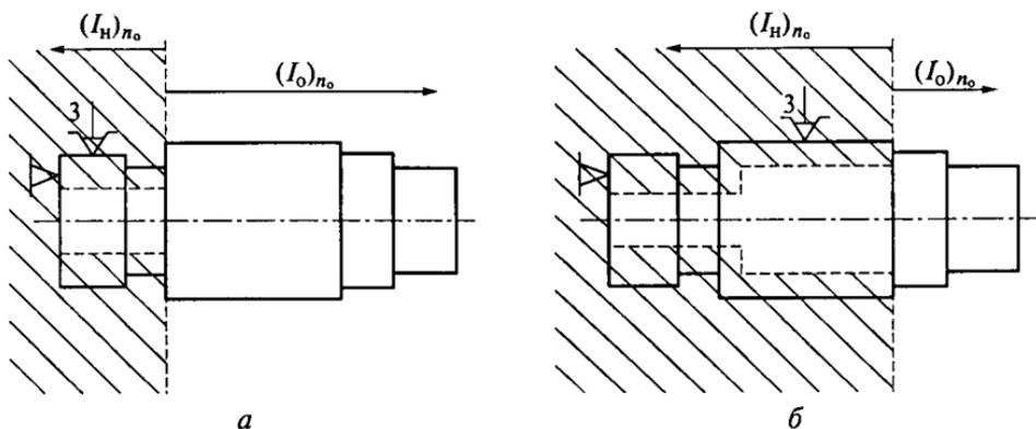
Рис. 7.5. Изменение зон возможной обработки в зависимости от состава (а), (б) базовых поверхностей заготовки в токарно-винторезной операции (заштрихованы зоны необрабатываемых поверхностей)
