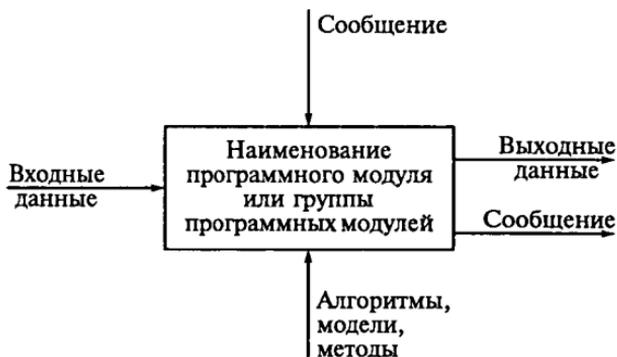
Рис. 7.12. Изображение программного модуля и его внешней среды
