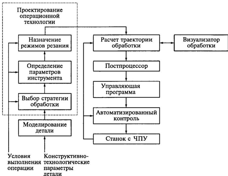
Рис. 7.1. Схема подготовки управляющих программ для станков с ЧПУ
