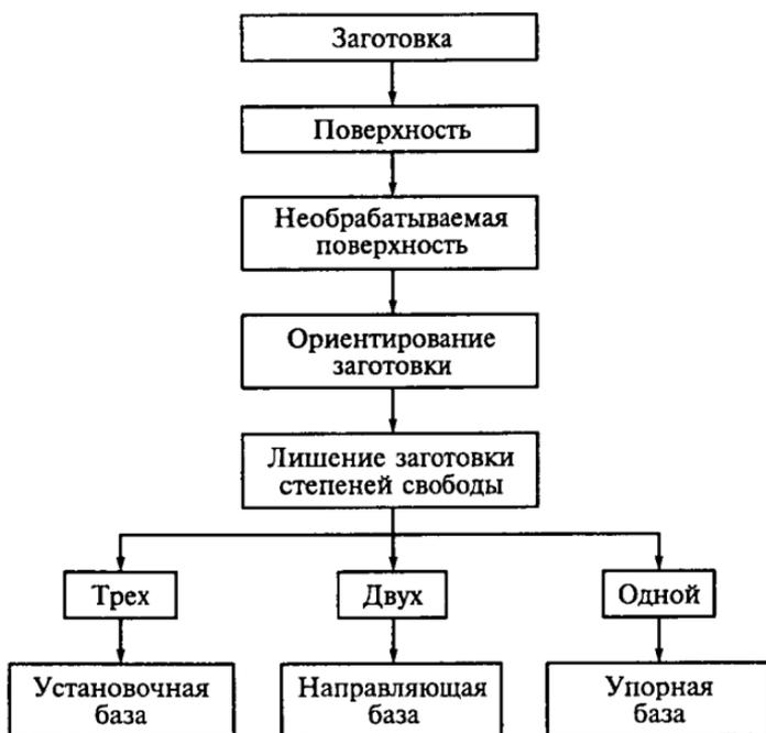
Рис. 3.1. Фрагмент семантической сети определения понятия «база»
