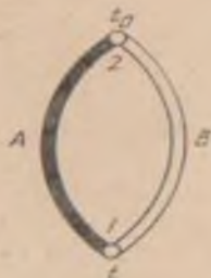
2—5- расм. Икки хил ўтказгичли термоэлектрик занжир.
