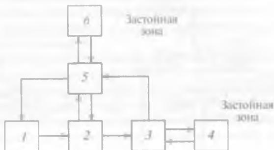
Рис. 6.5. Графическое представление квазиаппаратов в процессе перемешивания
