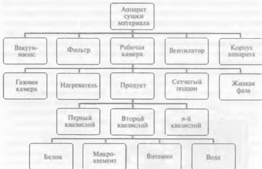
Рис. 11.7. Иерархическая структура технологического процесса сушки материала
