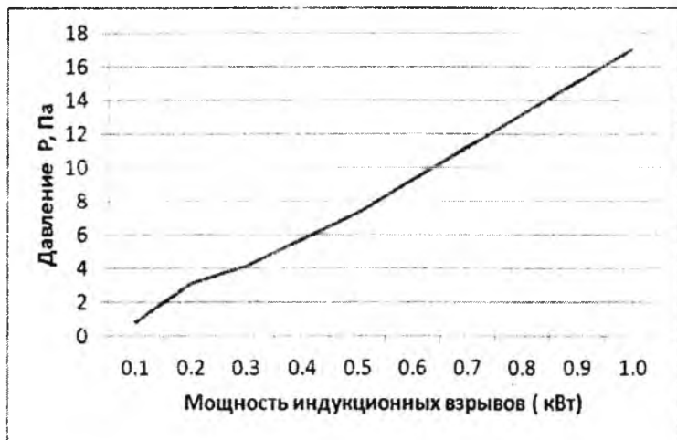
Рис. 3.4. График изменения параметров давления в плазмотроне от мощности индукционных импульсных взрывов
