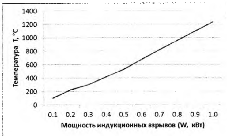
Рис. 3.3. График зависимости температуры в плазмотроне от мощности индукционных импульсных взрывов
