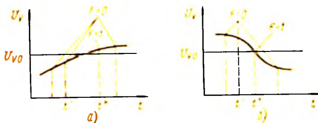
Рис. 11.11. Графическое представление действия макроэлемента «индикатор фронта (а) и среза (б)»
