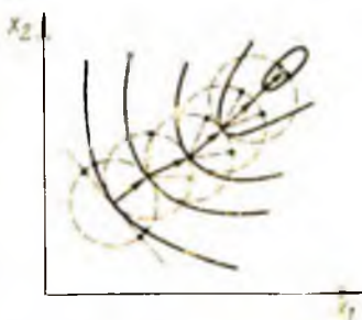
Рис. 14.3. Поиск экстремума случайным методом с перестраиваемым сектором
