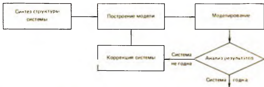
Рис. 3.2. Общая схема процесса проектирования структуры
