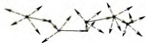
Рис. 14.4. Поиск экстремума случайным методом, учитывающим усредненное направление поиска на предыдущих шагах:
