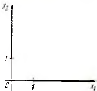
Рис. 15.1. Область допустимых решений при введении на переменные x_1 и x_2 ограничений вида x_1 + x_2 \geq 1 , x_1 x_2 = 0
