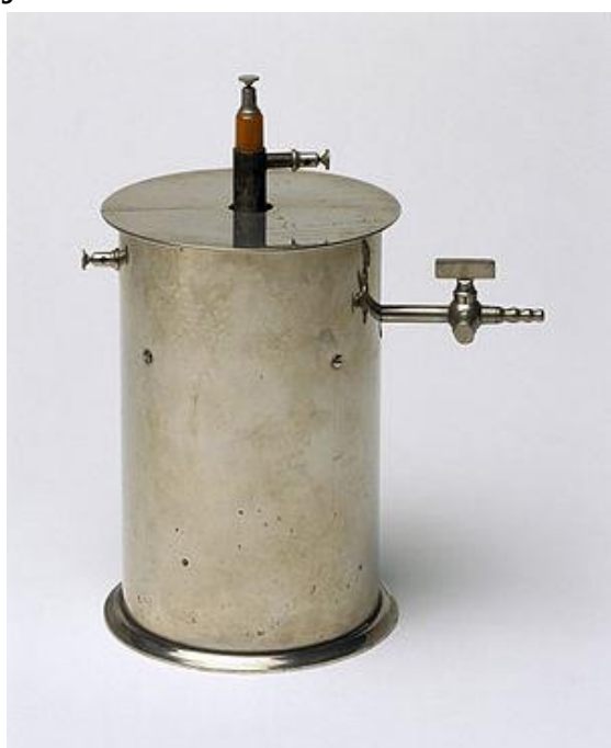
4.1-rasm. Pyer Kyuri 1895 - 1900 yy ishlatgan ionlashtiruvchi kamera
