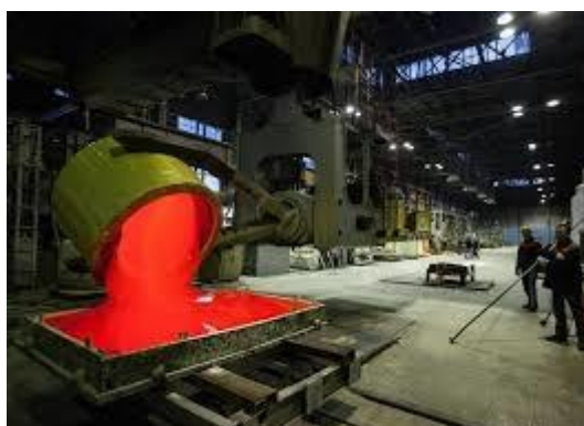
2.1-rasm. Shisha ishlab chiqarish uchun eritilgan xom-ashyoni qolipga quyish jarayoni
