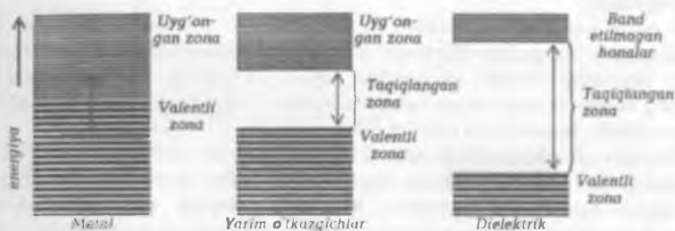
27.5-rasm. Metall, dielektrik va yarim o'tkazgichlar uchun taqiqlangan va o'tkazuvchan zonalar.
