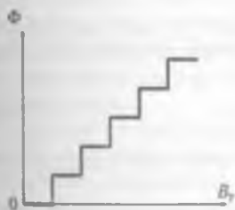
29.11-rasm. Halqa teshigida ushlanib qolgan magnit oqimi tashqi magnit maydon induktivitasiga bog'liqlik grafigi.
