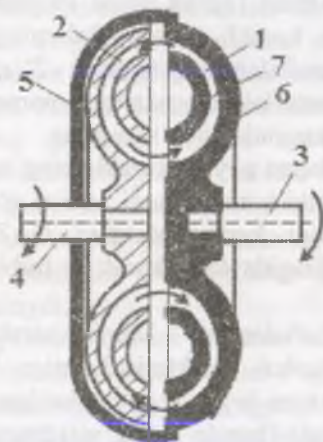
8.16.1-rasm. Hidrodinamik mufta yoki turbomufta nasos g'ildiragi 1-turbina g'ildiragi. 2 – yetaklovchi val. 3 – yetaklanuvchi val. 4 – diafragmalı bosqich. 5 – yarim korpus. 6 – yarim tor. 7 – lardan iborat.
