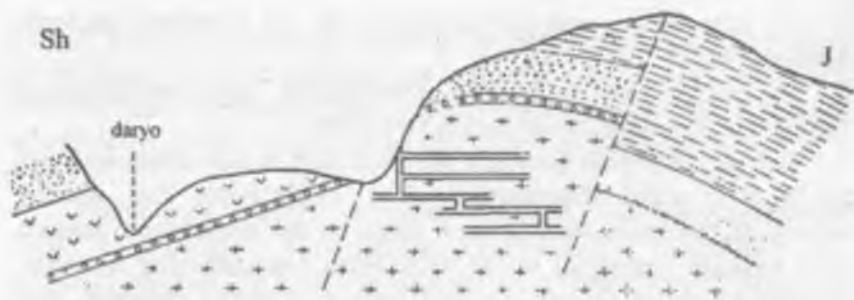
30-rasm. Bir polimetall koni misolida tomirli tana kesmasining bo'ylama profili.
