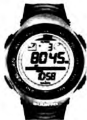
229 - rasm. Balandlikni o'lchash xususiyatiga ega LCD displeyli qo'l soati. Kuchlanish qora segmentlar yoki piksellarda qo'llaniladi. 8 soni hamma yettita segmentni (piksel) ishlatadi; qolgan raqamlar kamroq ishlatiladi
