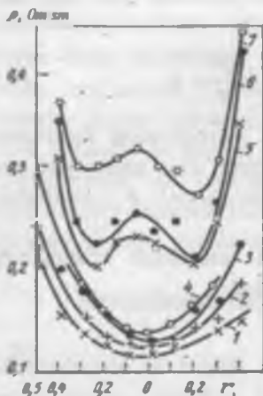
II 54-rasm. Aluminiiy kirishmasi kiritilgan kremniy monokristallarining ko'ndalang kesimi bo'yicha solishtirma elektr qarshilik taqsimoti:
