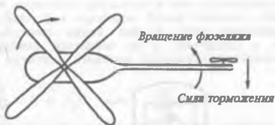
Рис. 3.7. Компенсация вращения вертолета торможением хвостового винта
