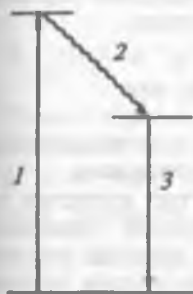
Рис. 9.29. Схема работы трехуровневого лазера: 1—накачка, 2—переход на метастабильный уровень, 3—излучение
