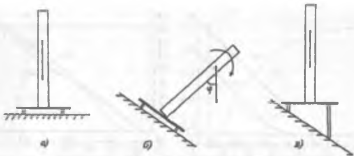
Рис. 2.10. Иллюстрация действия простейшей следящей системы, обеспечивающей вертикальное положение свободно стоящего на подставке бруска
