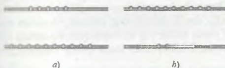
22.4-rasm. a) termodinamik muvozanat; b) inversiya holati.
