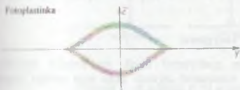
18.7-rasm. Shtern-Gerlax tajribasida kumush atomlarini fotoplastinkada joylanishi.
