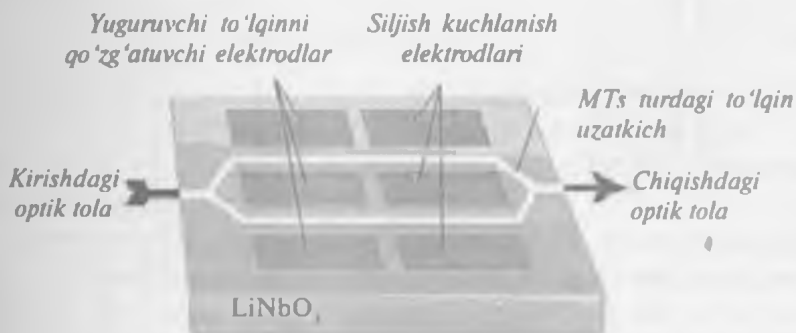
6.7-rasm. Max-Tsender interferometri turidagi elektrooptik modulyatorning tuzilish sxemasi.
