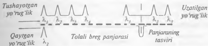
9.6-rasm. Tolali bregg panjarasida guruhliy signaldan muayyan to'liqin uzunlikli kanalni ajratish jarayoni.
