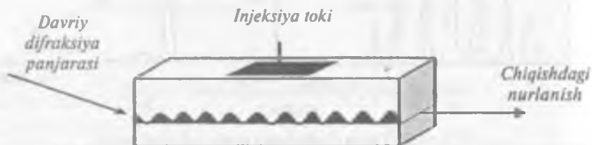
3.23-rasm. Taqsimlangan teskari aloqali yarimo'tkazgichli lazer diodi
