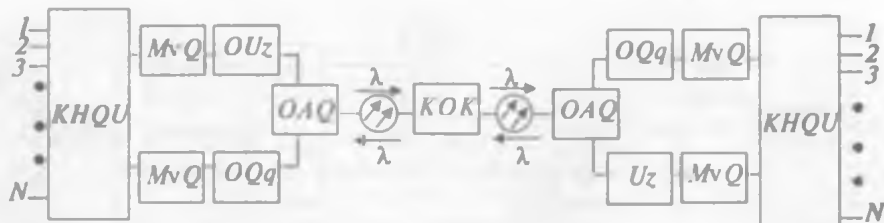
1.7-rasm. Bir tolali, bir polosali, bir kabelli TOAT sxemasi
