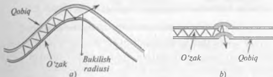
2.16-rasm. Optik tolaning makrobukilishlari (a) va mikrobukilishlari (b)
