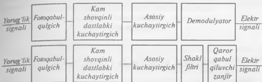
4.16-rasm. Analog (a) va raqamli (b) signallarni qabul qiluvchi optoelektron modulning tarkibiy funksional elementlari
