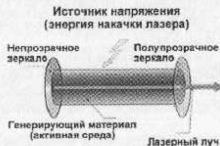
Рис. 2.1. Обобщенный лазер состоит из лазерной активной среды, системы «накачки» - источника напряжения и оптического резонатора.
