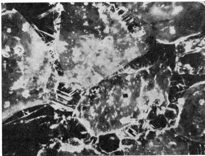
Рис. 8.28. Образование новой кристаллической прослойки между частицами формовочной смеси при нагревании формовочной смеси с 0,5% FeO до 1373° K ( $\times 75$ )
