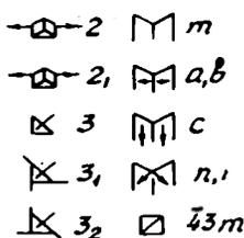
Рис. 1.23. Условные обозначения элементов симметрии, расположенных косо по отношению к плоскости чертежа
