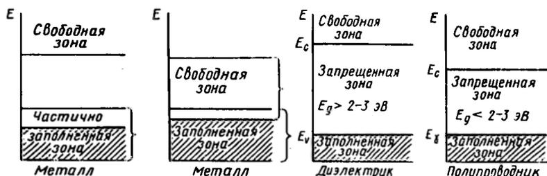
Рис. 7.14. Заполнение зон электронами:  $E_v$  — граница валентной зоны,  $E_c$  — граница зоны проводимости,  $E_g$  — ширина запрещенной зоны
