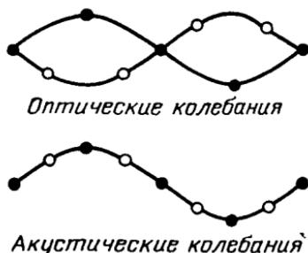
Рис. 4-10. Схематическое изображение колебаний частиц в двухатомной линейной решетке, иллюстрирующее природу различия между оптическими и акустическими колебаниями. Предполагается, что колебания поперечные и что длина волны обоих типов колебаний одинакова.
