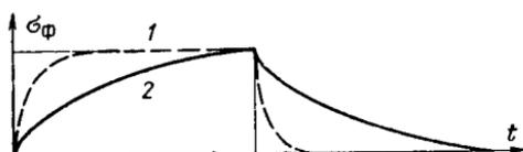
Рис. 11-7. Кривые релаксации фотопроводимости при отсутствии (1) и при наличии (2) уровней прилипания.
