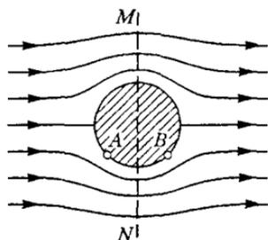
Рис. 227. Обтекание симметричного тела равномерным потоком воздуха
