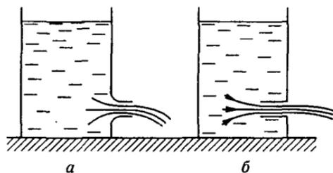
Рис. 223. Зависимость сечения вытекающей струи от формы отверстия
