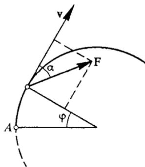
Рис. 90. Сила трения при разгоне по кольцевой трассе
