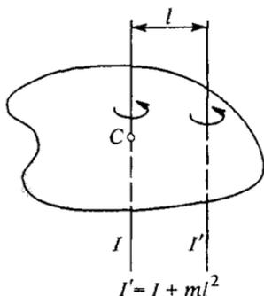
Рис. 155. Моменты инерции относительно параллельных осей
