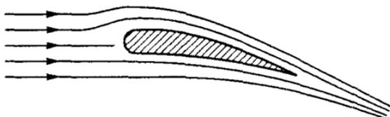
Рис. 233. Линии тока при обтекании крыла
