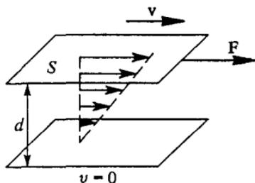
Рис. 225. Вязкая жидкость между плоскими пластинами
