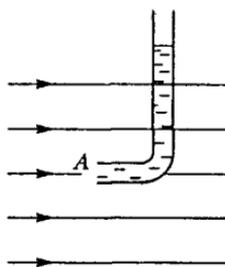
Рис. 220. Манометрическая трубка с открытым концом
