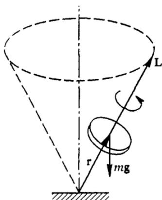
Рис. 157. Прецессия гироскопа
