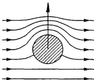
Рис. 229. Обтекание вращающегося цилиндра набегающим потоком
