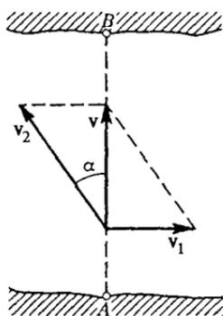
Рис. 17. Сложение скоростей при переправе поперек реки
