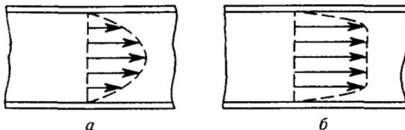
Рис. 226. Профиль скоростей при ламинарном (а) и турбулентном (б) течении жидкости по трубе
