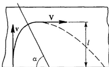
Рис. 107. Траектория шайбы в неподвижной системе отсчета
