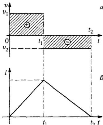
Рис. 35. На графике скорости расстояние изображается заштрихованной площадью
