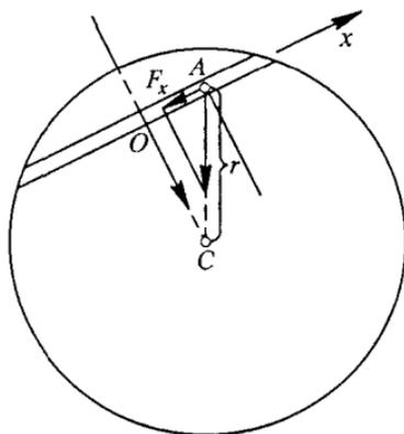
Рис. 174. Движение в туннели, прорытом сквозь земной шар
