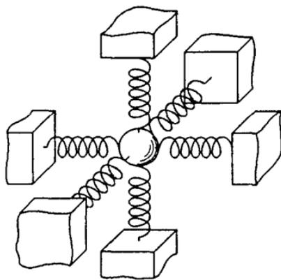
Рис. 104. Изотропный осциллятор (три пары взаимно перпендикулярных пружин)
