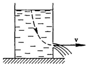
Рис. 222. К расчету скорости истечения жидкости из отверстия
