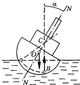
Рис. 214. Устойчивость плавания корабля в вертикальном положении
