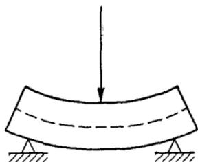
Рис. 101. Изгиб балки, лежащей на двух опорах
