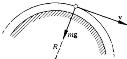
Рис. 94. Движение по низкой круговой орбите
