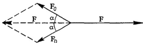
Рис. 63. Сложение сил и градуировка динамометра
