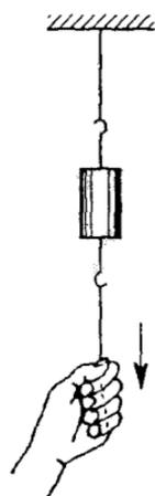
Рис. 67. Опыт, иллюстрирующий инертность
