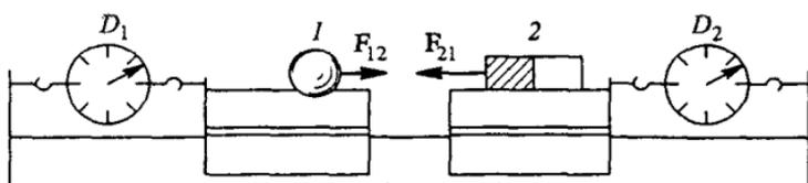
Рис. 68. Показания динамометров  $D_1$  и  $D_2$  одинаковы
