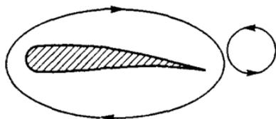
Рис. 232. К возникновению циркуляции воздуха вокруг крыла самолета
