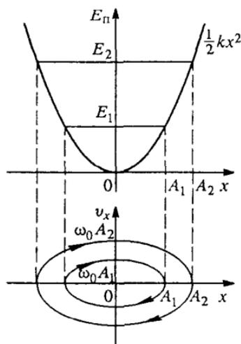
Рис. 164. Потенциальная энергия и фазовая энергия осциллятора
