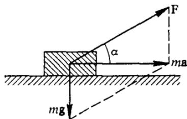
Рис. 84. Сложение сил при  $Q=0$
