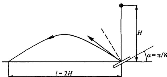
Рис. 57. Расположение плиты для наибольшей дальности полета шарика
