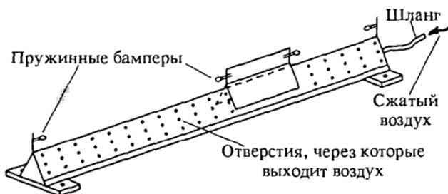
Рис. 61. Дорожка с воздушной подушкой, обеспечивающей движение с очень малым ускорением
