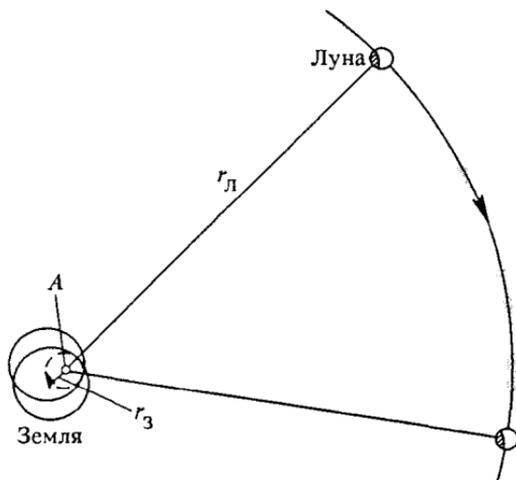
Рис. 69. Ценры Земли и Луны движутся по окружностям радиусов  $r_з$  и  $r_л$  с общим центром в точке А
