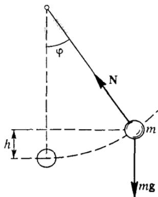
Рис. 119. Силы, действующие на груз, подвешенный на стержне
