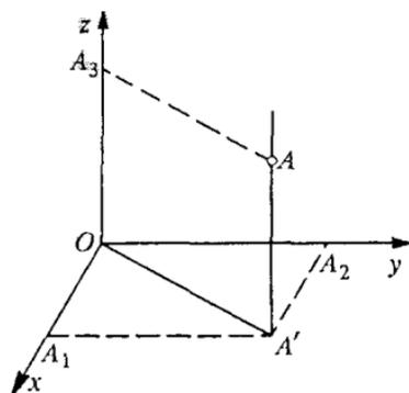
Рис. 53. Декартова система координат
