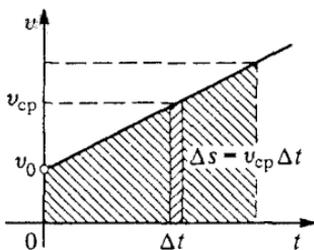
Рис. 38. Определение пути по графику скорости
