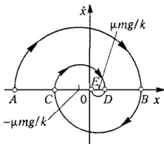
Рис. 171. Фазовая траектория затухающих колебаний при сухом трении
