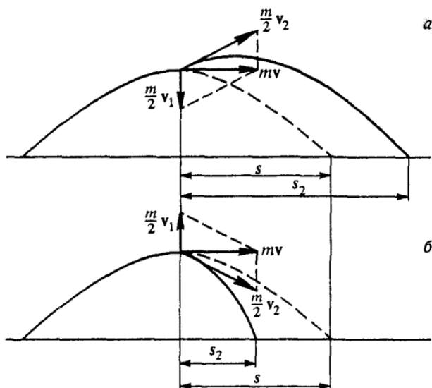
Рис. 108. Траектория осколков после разрыва снаряда
