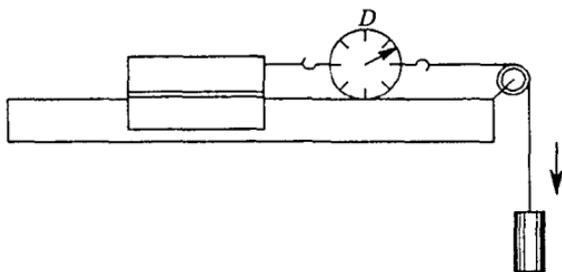
Рис. 65. Опыт на воздушной дорожке, в котором проверяется пропорциональность ускорения и силы
