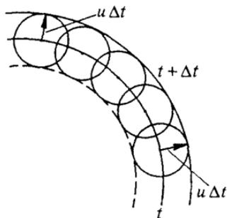
Рис. 203. Построение волновой поверхности по принципу Гюйгенса
