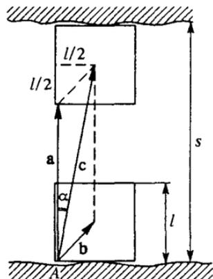
Рис. 11. Сложение перемещений при переправе на пароме
