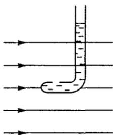
Рис. 219. Манометрическая трубка в потоке
