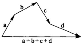
Рис. 9. Сложение большого числа векторов
