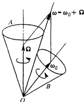
Рис. 153. Качение конуса  $B$  по поверхности конуса  $A$
