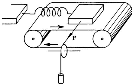
Рис. 88. Брусок на движущейся ленте транспортера
