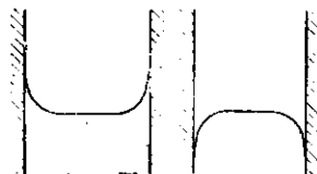
Рис. 7.10. Мениски при смачивании (слева) и при несмачивании (справа) твердых стенок.
