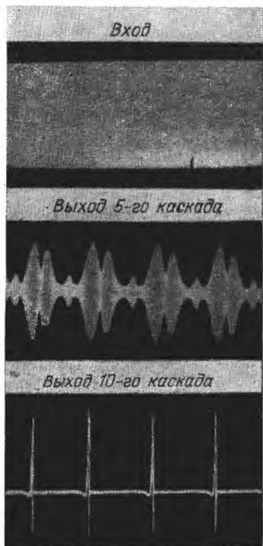
Рис. 4.1. Огибающие напряжения на выходе разных каскадов УЧ в случае постоянного (сильноинерционного для пульсаций) смещения.
