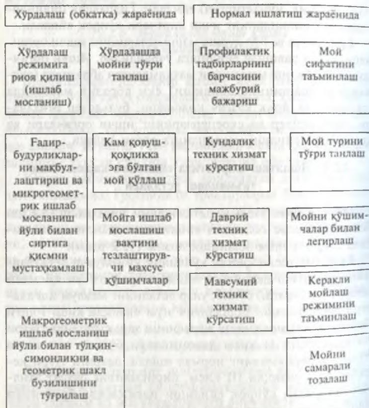
12.2-расм. Ишлатиш шароитида сйилишни камайтириш схемаси
