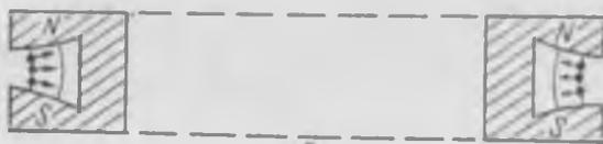
27- расм. Вертикал—фокусловчи кучлар йўналиши (а—циклотрон; б — синхрофазотрон).
