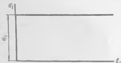
Рис. 5.15. Схематизированная диаграмма деформирования идеального жестко-пластического тела
