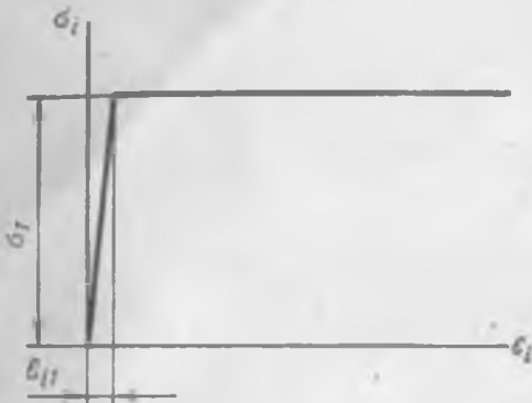
Рис. 4.4. Диаграмма деформирования идеального упруго-пластического материала
