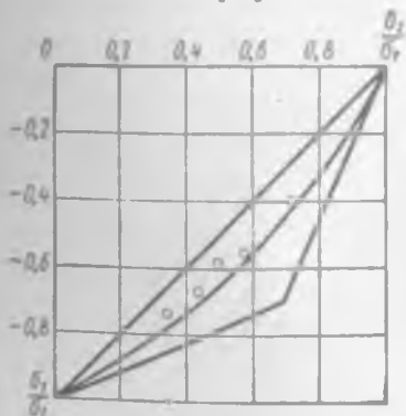
Рис. 3.6. Результаты испытаний стальных труб, проведенных Рошем и Эйхнгером [14]
