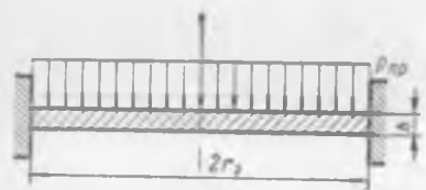
Рис. 10.31. Круглая пластина заделана по контуру и нагружена равномерно распределенной нагрузкой
