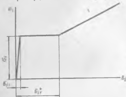
Рис. 5.7. Схематизированная диаграмма деформирования с площадкой текучности и линейным упрочнением
