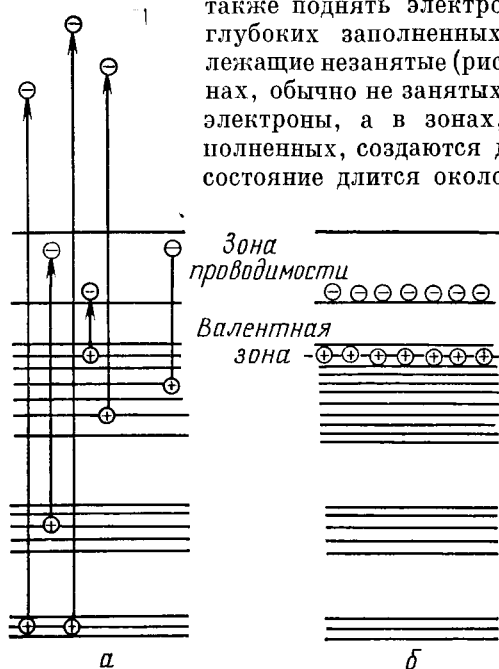
Рис. 6.3. Образование электронно-дырочных пар заряженной частицей.
