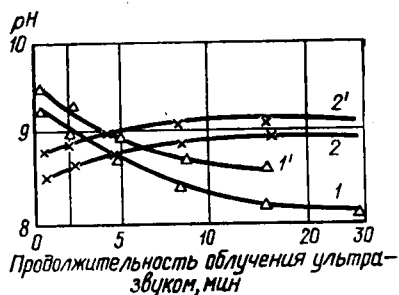
Рис. 10.2. Изменение pH в растворах карбонатной комплексной соли при различной продолжительности озвучивания:
