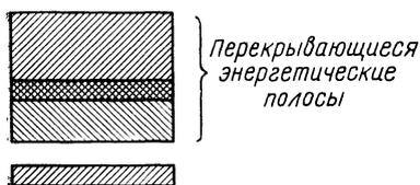
Рис. 20.3. Неперекрывающиеся энергетические полосы разделяются запрещенной полосой.
