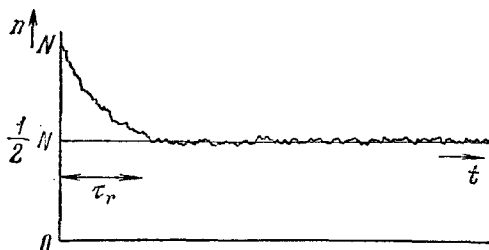
Рис. 1.12. Диаграмма показывает изменение со временем числа молекул n в левой половине ящика на рис. 1.11 после поднятия перегородки. Время релаксации обозначено через \tau_r .
