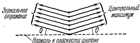
Рис. 9.18. Направления интерференционного максимума для антенн, возбуждаемых с фазовыми соотношениями рис. 9.17.
