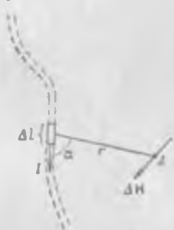
Рис. 187. Элемент тока \Delta l создает в точке A напряженность магнитного поля \Delta H , перпендикулярную к плоскости, содержащей \Delta l и радиус-вектор r .
