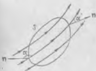
Рис. 185. Поток линий напряженности через замкнутую поверхность.
