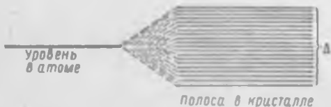
Рис. 135. Расщепление электронного уровня при образовании кристалла.
