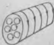
Рис. 227. Амперовы токи в постоянном магните.
