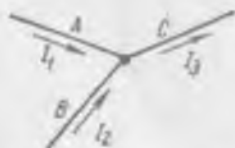
Рис. 111. Узел, образованный тремя проводниками A, B, C.
