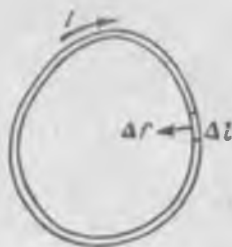
Рис. 201. Сила, действующая на элемент \Delta l контура с током, расположенного перпендикулярно напряженности магнитного поля.
