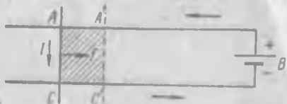
Рис. 291. К выводу выражения электродвижущей силы индукции.
