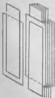
Рис. 70. Плоский конденсатор из листов фольги, переложенных листками парафинированной бумаги.
