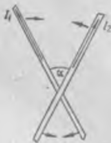
Рис. 200. Взаимодействие двух прямолинейных токов, текущих под углом \alpha друг к другу.
