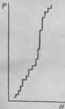
Рис. 225. Скачкообразное нарастание намагничивания ферромагнетика.
