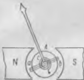
Рис. 256. Схема гальванометра с подвижной рамкой.
