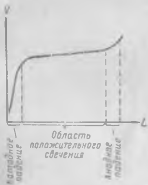
Рис. 172. Падение потенциала вдоль разрядной трубки.
