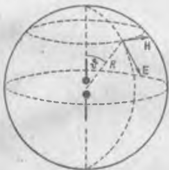
Рис. 350. Направление векторов E и H в волновой зоне диполя.
