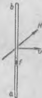
Рис. 292. Направление силы Лоренца, действующей на заряд при перемещении проводника во внешнем магнитном поле H .
