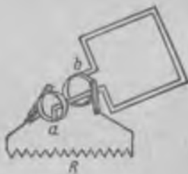
Рис. 310. Отведение тока от вращающейся рамки с помощью колец a и b .
