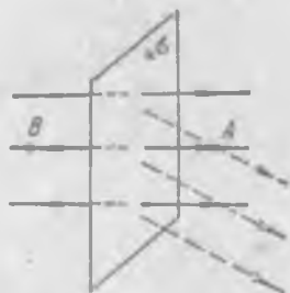
Рис. 26. Линии напряженности поля бесконечной плоскости.
