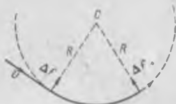
Рис. 270. Сила \Delta f , действующая на заряд, движущийся перпендикулярно к направлению магнитного поля.
