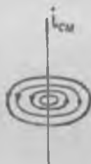
Рис. 339. Возникновение concentрических круговых линий магнитной напряженности вокруг вектора плотности тока смещения i_{cm} .
