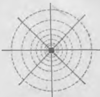
Рис. 36. Поверхности уровня потенциала (пунктирные линии) и линии напряженности (сплошные линии) точечного заряда.
