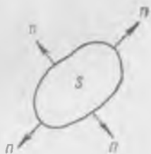
Рис. 85. Внешние нормали к замкнутой поверхности S .
