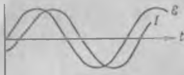
Рис. 304. Кривые изменения со временем э. д. с. \mathcal{E} и силы тока I в случае переменного тока в цепи с самоиндукцией.
