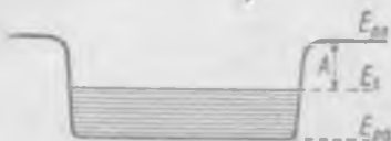
Рис. 123. Неполное заполнение энергетических уровней в кристалле.
