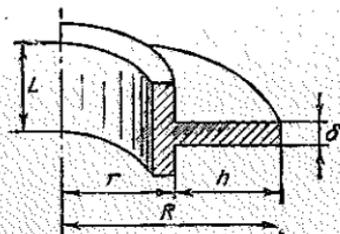
Рис. 2.3. Круглое ребро постоянной толщины
