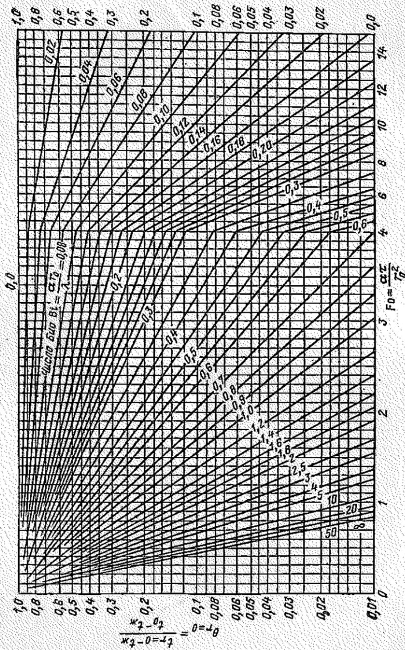
Рис. П.3. Безразмерная температура  $\theta$  для оси цилиндра в зависимости от  $Bi$  и  $Fo$
