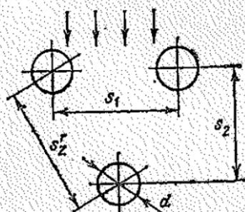
Рис. 6.4. Геометрические параметры шахматного пучка
