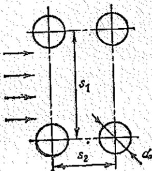
Рис. 6.5. Геометрические параметры коридорного пучка
