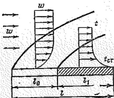
Рис. 6.1. Пластина с необогреваемым начальным участком длиной  $l_0$
