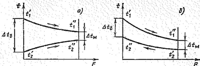
Рис. 12.1. Температурные графики при прямомтоке (а) и противотоке (б)
