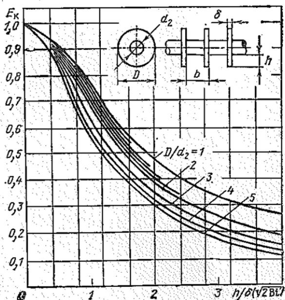
Рис. П.8. Коэффициент эффективности  $E_k$  круглого ребра
