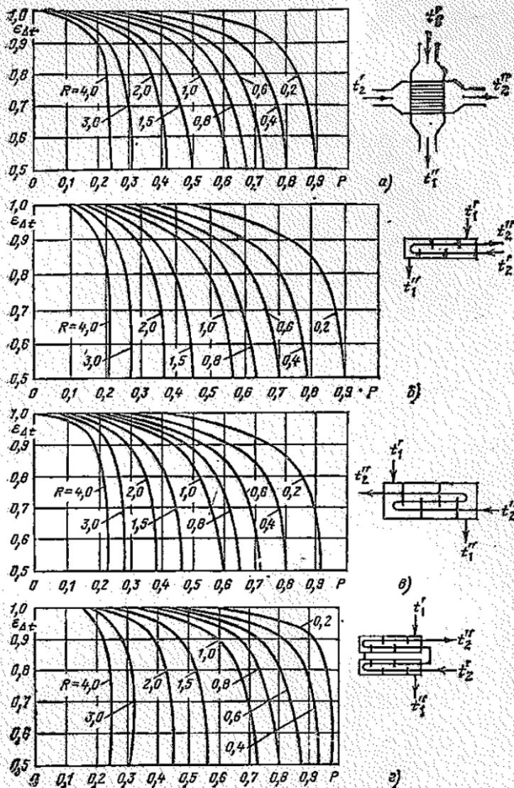
Рис. П.14. Определение  $\epsilon_{\Delta t}$  для расчета среднелогарифмического температурного напора при различных схемах движения теплоносителей в теплообменнике:
