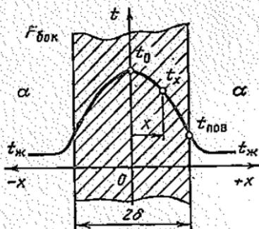
Рис. 3.1. Температурный график в пластине с учетом внутренних источников теплоты
