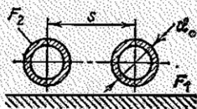
Рис. 10.3. Лучистый теплообмен между трубами и стенкой
