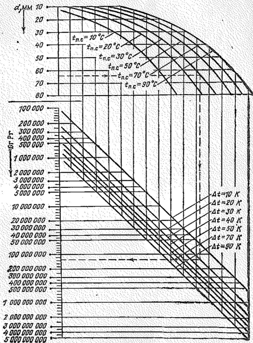
Рис. П.9. Определение произведения чисел  $(Gr Pr)_{п.с}$  для воды: на номограмме линии:  $t_{п.с}$  — средняя температура пограничного слоя,  $t_{п.с} = 0,5(t_c + t_n)$ ;  $\Delta t$  — разность температур стенки и воды,  $\Delta t = t_c - t_n$ . Пример на номограмме: наружный диаметр трубы  $d=64$  мм,  $t_{п.с}=30^\circ\text{C}$ ,  $\Delta t=20$  К; находим  $(Gr Pr)_{п.с} \approx 135 \cdot 10^5$ .
