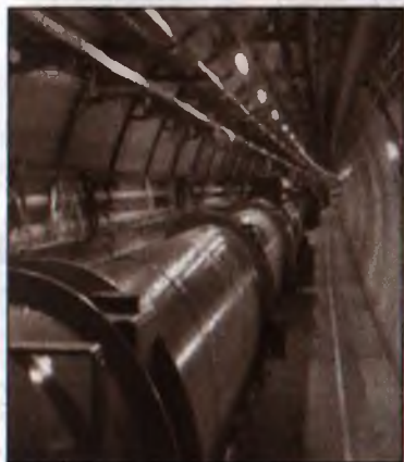
22.2-расм. Катга Адронли тезлаттичининг ўта ўтказувчан диполи системаси
