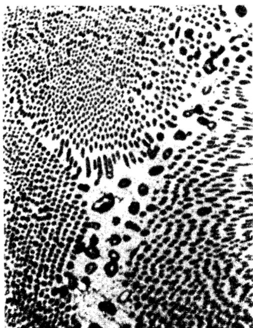
Фото 15. Микроструктура эвтектики в сплаве кадмий — олово.
