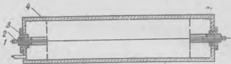
31- расм. Цилиндрик счётчикнинг схематик кўриниши: 1 — йиғувчи электрод, 2 — сақлагич ҳалқа, 3 — изолятор, 4 — корпус.
