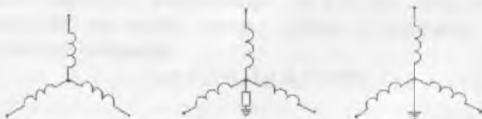
15.1-rasm. Neytrali yerga bevosita ulangan tizim.
