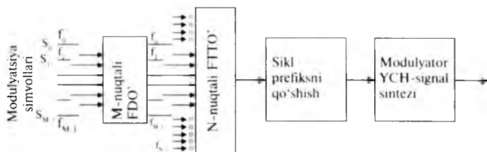
20.6-rasm. E-UTRAN tarmog'idagi "yuqoriga" yo'nalishda uzatishda SC-FDMA texnologiyasi yordamida signalni qayta ishlash sxemasi.
