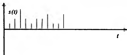
13-rasm. Kattalik bo'yicha uzluksiz va vaqt bo'yicha diskret signal
