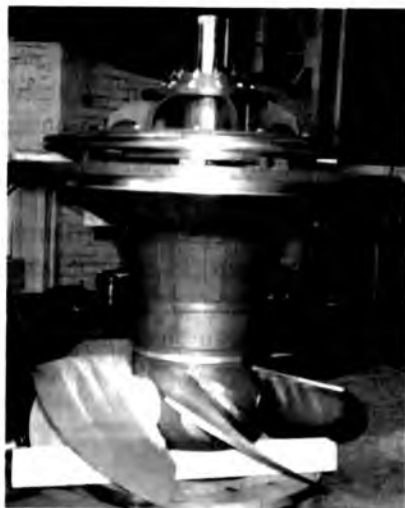
36-rasm. Parrakli turbina rotorining yig'ilgan holatdagi ko'rinishi.
