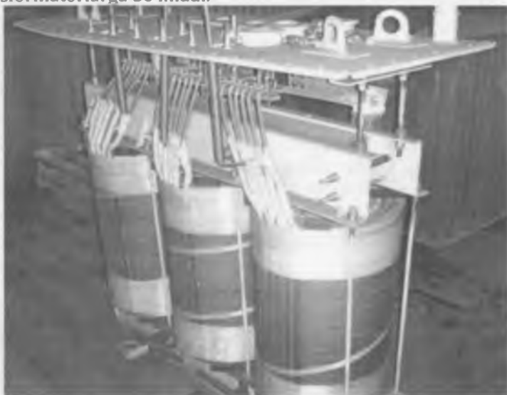
7.2 -rasm. Uch fazali transformatorni aktiv qismining ko'rinishi
