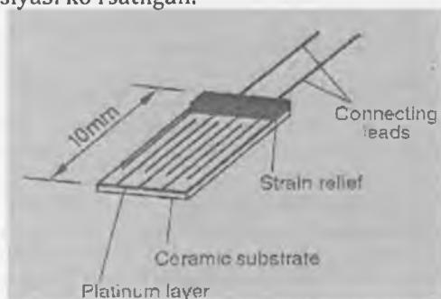
3.6- rasm. Platina yotqizilgan qarshilik termometrining konstruksiyasi
