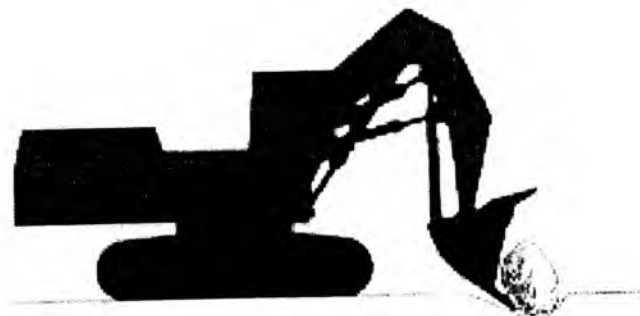
3.4-rasm. Ekskavator yordamida toshlarni surishning oqibatlari
