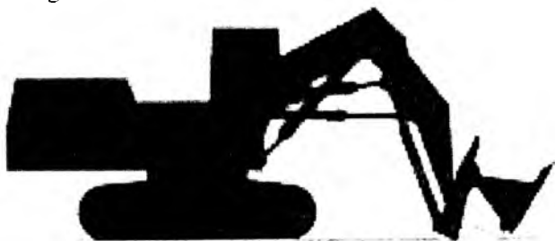
3.6-rasm. Ekskavator kovushini orqa tomoni bilan zaminni tekislashni salbiy oqibati
