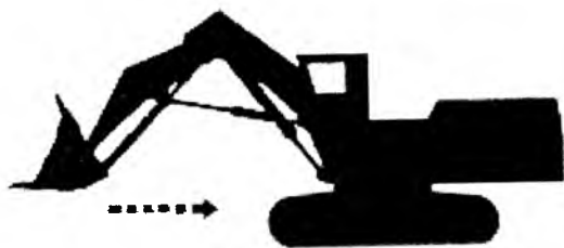
3.3-rasm. Ekskavatorni qazish vaqtida gusinitsaga kovushning tegib ketishi
