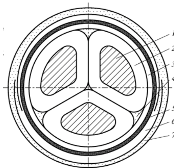
17-rasm. Belboq izolyatsiyali va sektor simlari zichlangan uch simli kabellar.
