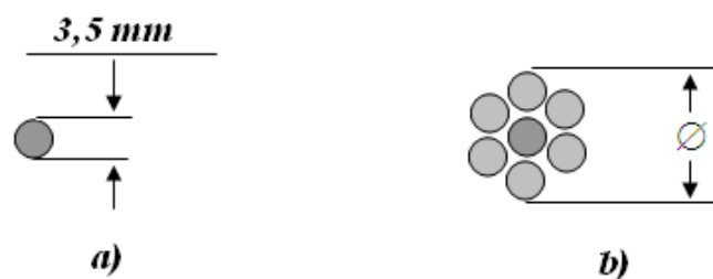
18.2 – rasm. Alyuminiy-po`lat sim o`tkazgichning konstruktiv tuzulishi. a) bir simli po`lat o`tkazgich; b) alyuminiy po`lat (AS) o`tkazgich.
