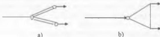
10.1.1- rasm. Tarmoq sxemasining variantlari a) radial; b) berk zanjirli.
